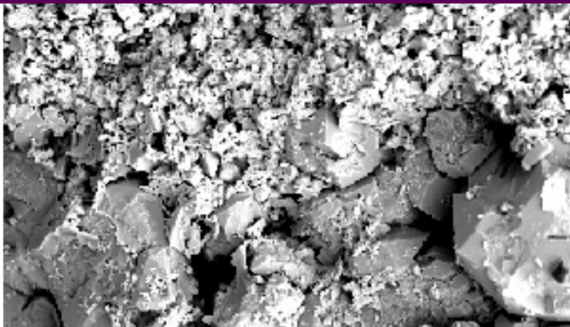
Posibles cristales de sal recubiertos de polímero dentro de la formación.
