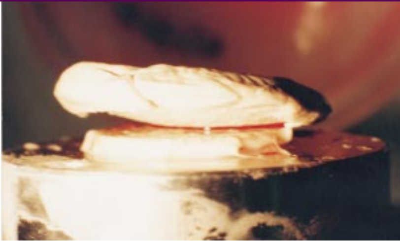
Revoque VISPLEX a una contrapresión de 4 lpc.
