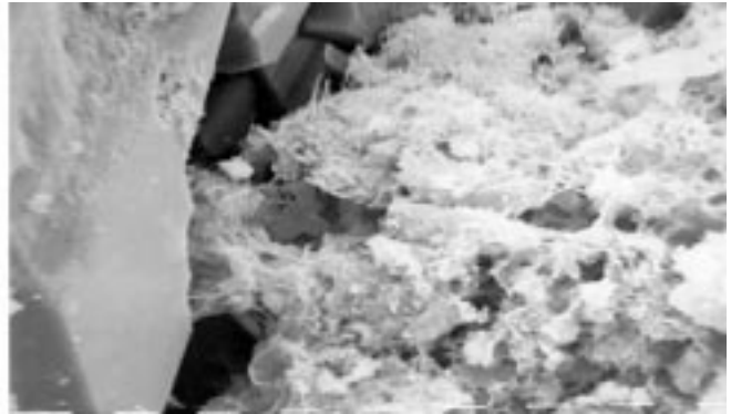
Fotografía SEM de una capa mixta de illita y esmectita que obstruye el espacio poroso.
