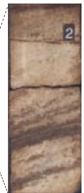
D=grupos de laminaciones cruzadas en la imagen y el núcleo E=cementación de calcita en parches.
