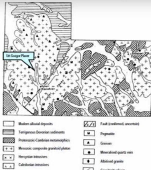
Figura 5. Mapa geológico de Janchivian y placeres de Ta-Nb-Sn-Ti-REES-Au localizados en el valle de UrtGozgor.
