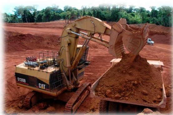
Figura 2. Pala frontal de 860 hp cargando un camión de 100 t, en un frente de extracción en la mina de bauxita de Los Pijiguaos. Para manejar la calidad de la bauxita en forma eficiente, se mantienen operando tres (03) frentes diferentes al mismo tiempo, “dosificando” el número de camiones en la tolva de alimentación, a la entrada de la planta de trituración. Imagen institucional de CVG Bauxilum tomada de internet.
