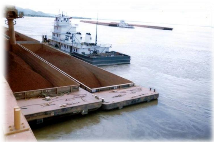
Figura 3. Operación de carga de gabarras en el muelle de El Jobal, sobre el río Orinoco. Al fondo, un punto de amarre de gabarras, sobre el río Orinoco, con el empujador de maniobras. Al conformarse un tren de gabarras, se navega “aguas abajo” por 634 km (350 millas) hasta el muelle de Matanzas, para descargar la bauxita en los patios de la refinadora. Imagen institucional de CVG Bauxilum tomada de internet.
