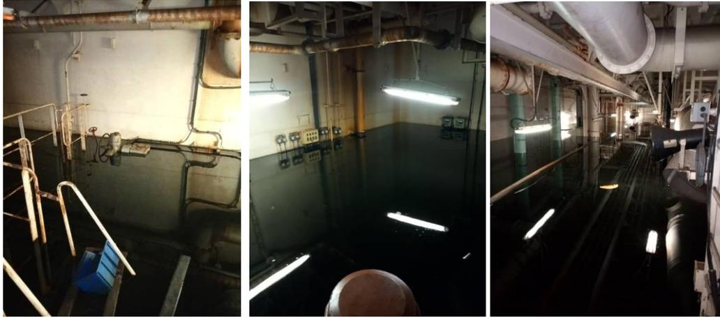
Figura 21. Vista del agua en las cubiertas inferiores del FSO NABARIMA (Fotos cortesía de la tripulación del FSO Nabarima que deseaban permanecer anónimos)
