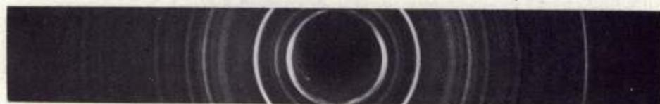
Fig. 3. Imagen negativa de la película de la cámara Debye-Scherrer de 116,4 mm  $\phi$ .
