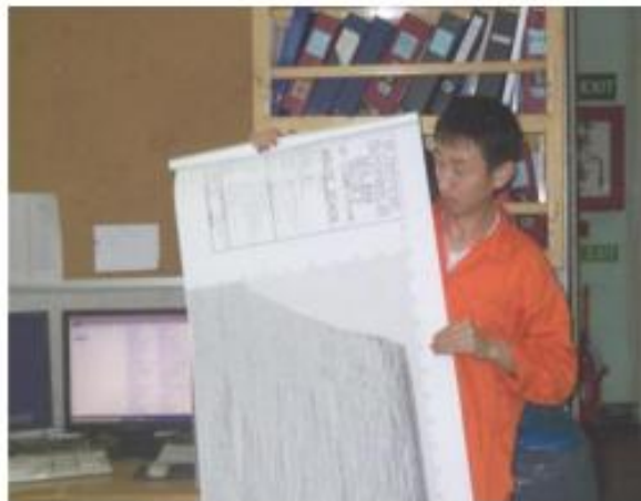
Figura 7. Ejemplo de sección sísmica lista para su interpretación, cuando se hacía la interpretación en papel. Fuente: ION-GX-Technology (2009).
