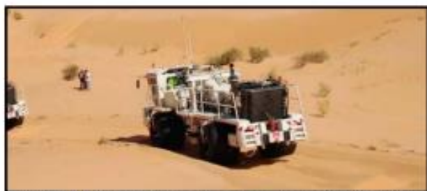
Figura 19. Camión vibrador que se usa como generador de energía sísmica, trabajando en una región desértica. Fuente: Di Giulio (2017).
