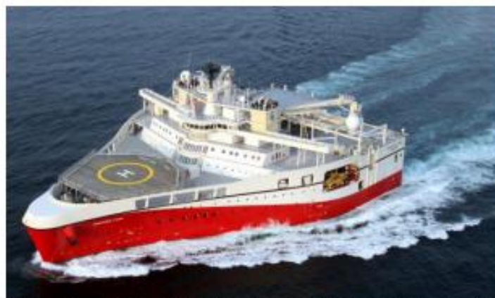
Figura 17. Barco para adquisición de datos sísmicos de reflexión de la empresa PGS, 2013. Es uno de los barcos más eficientes y potentes del mundo. Fuente: Internet, vadebarcos.net.
