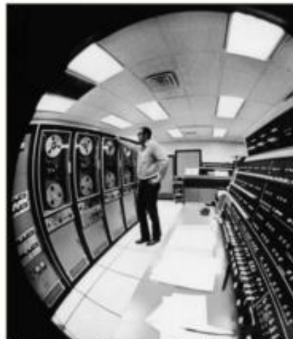
Figura 6. Primer equipo de procesamiento digital especialmente hecho para datos sísmicos, el TLAC 827 fue construido por Texas Instrument. Este computador digital fue instalado en el Centro de Procesamiento de GSI en Calgary, Canadá, en 1964. Fuente: Dragoset (1975).
