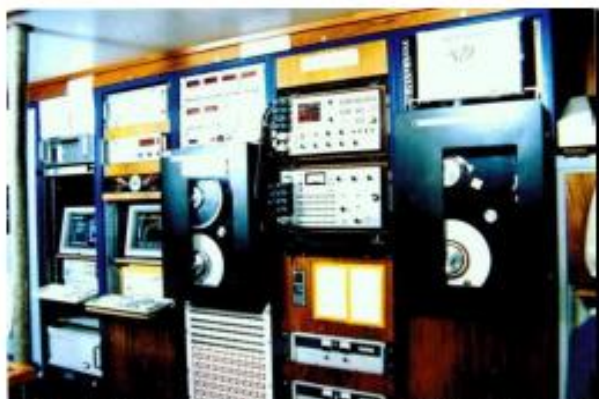
Figura 5. Primer equipo de grabación de datos sísmicos digitales, el DFS V, que fue al campo en 1961. Fuente: Schlumberger (2011), Part 8.
