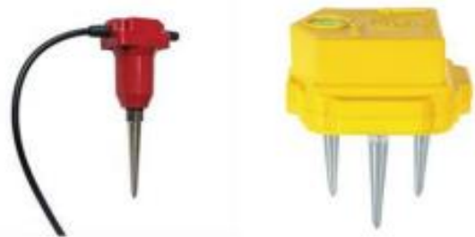
Figura 14. A la izquierda geófono vertical para ondas P. A la derecha geófono de tres componentes, vertical P y dos horizontales SV y SH, perpendiculares entre sí. Fuente: Imágenes Google.
