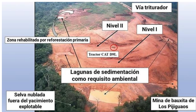
Figura 7 – Ejemplo práctico del programa de construcción de canales perimetrales, lagunas de sedimentación y control de escorrentía en el bloque 1, de la mina de bauxita de Los Pijiguaos, junto a una zona rehabilitada por reforestación primaria. El tractor D9L (círculo rojo) sirve de escala gráfica. Fuente: imagen y elaboración propia.
