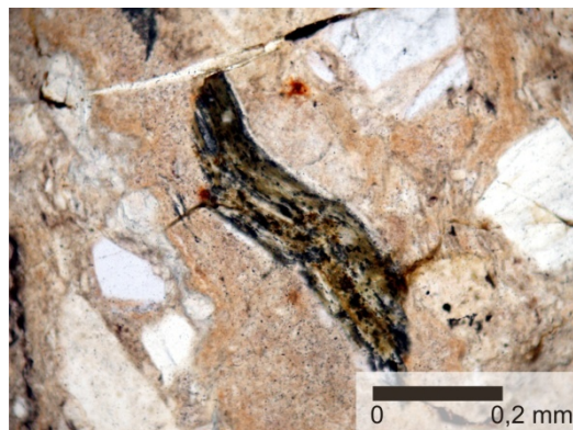
B.54. Idem, nótese las manchas de óxidos en su superficie, originadas por la alteración. Foto en N=.
