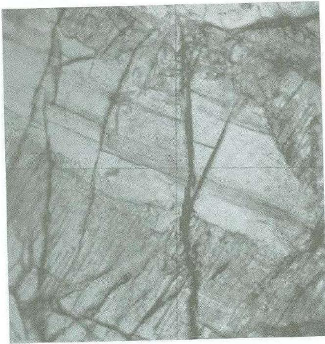
Fig. 11. Foto de las diabasas hipersténica. Nótese hipersteno, intercrecimiento de hipersteno con laminillas de diópsido (pigeonita invertida) y cristales de plagioclasas.
