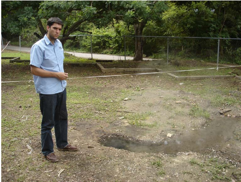
Hoyo de la perforación de aproximadamente 25 m de profundidad y de cuyo orificio brota agua termal la cual fluye en el terreno adyacente (abajo).
