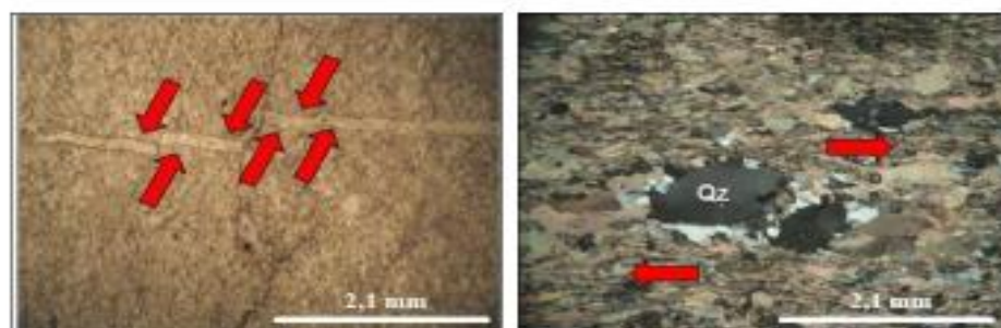
Figura 10. Mármol puro (calcítico) con veta de calcita fracturada en escalón en sentido normal (flechas rojas) Izquierda, 15SUT14-005, nicoles paralelos. Mármol impuro (calcítico-dolomítico impuro) con porfidoclastos de cuarzo sigmoidales indicando cizallamiento dextral (flechas rojas). Derecha, 15SUT7-017, nicoles cruzados.
