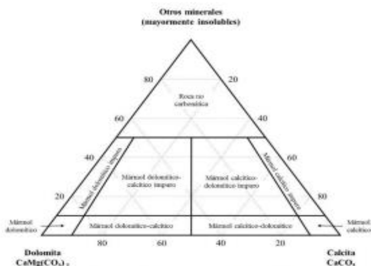
Figura 3. Diagrama ternario para la clasificación mineralógica de rocas carbonáticas (modificado de CARR et al. , 1994).
