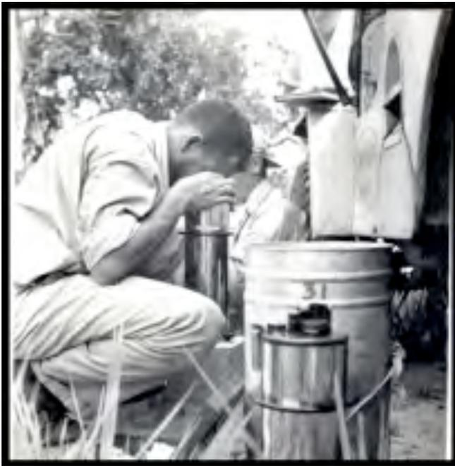
Fig. 5. Operación de gravímetros Worden.
