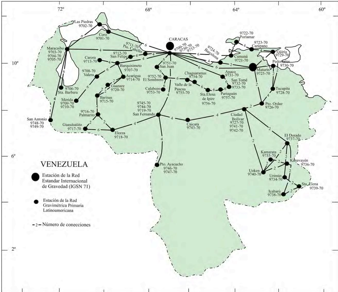
Fig. 10. Estaciones de la red de referencia gravimétrica levantada en 1982 (Modificado de Graterol, 1994).
