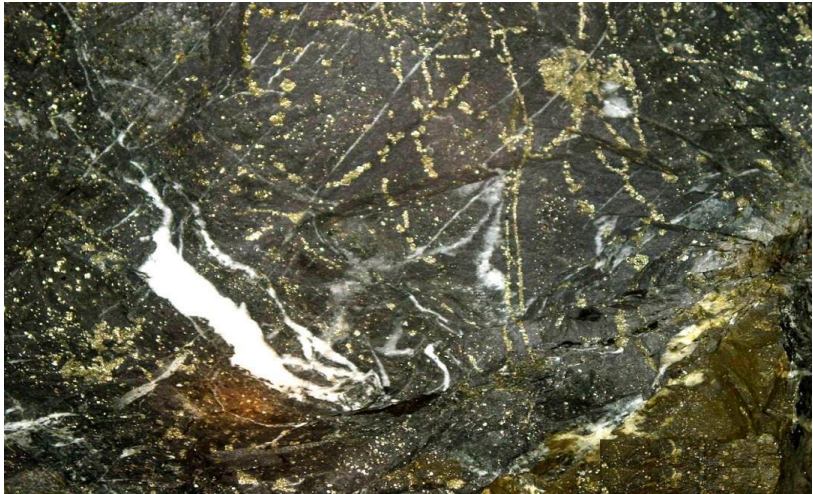
Figura 18. “Bolsón” mineralizado de alto tenor en el nivel 6 de la Mina Colombia de CVG Minerven, El Callao. Aquí las vetas de cuarzo aurífero, tipo Colombia y América, han desaparecido y sólo se observan fragmentos brechados y no brechados de cuarzo y vetillas de cuarzo en rocas ultramáficas muy alteradas y altamente piritizadas (>15%. Tomado de Mendoza, 2000).
