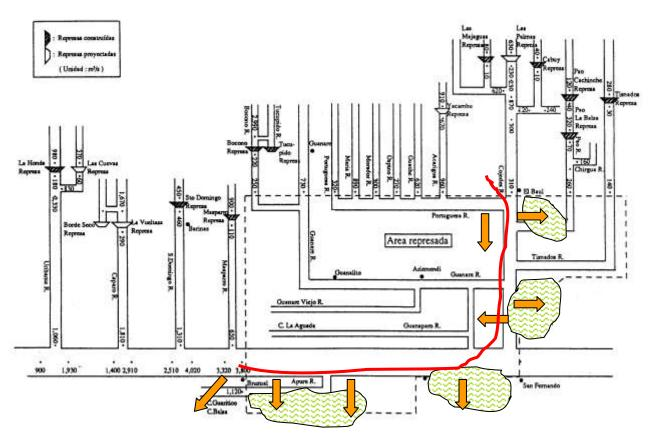
Figura 8.3. Sobre la figura del proyecto PROA, se han colocado los principales patrones de flujo de agua (en flechas gruesas de color naranja), que ocurren durante los eventos de inundación de esteros y bajíos en la zona. Los esteros y bajíos, se representan como áreas de color verde; la línea gruesa de color rojo representa el límite del área donde se ejercerá el mayor control de inundaciones.
