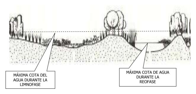
Figura 4.4. Corte esquemático de una zona de inundación en un río en los llanos inundables, donde se pueden apreciar las cotas máximas y mínimas alcanzadas por las aguas. En algunos casos, la zona de inundación, que el dibujo se haya a la izquierda, puede conservar agua durante todo el año; mientras que en otros casos, ésta zona puede secarse completamente.
