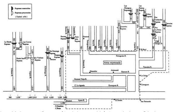
Figura 8.2. Representación esquemática de la cuenca del río Apure, donde se señalan las represas construidas y las que están en estudios, en el contexto del proyecto PROA. Los valores representan las descargas de los principales ríos del área (tomado del informe del proyecto PROA, septiembre de 1993).
