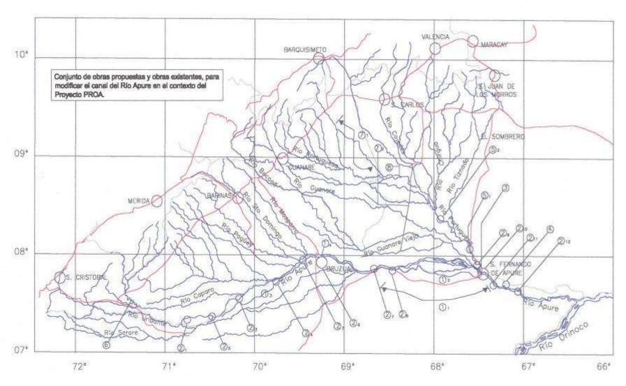
Figura 8.1. Mapa general de la cuenca del Río Apure, donde se señala el núcleo principal de influencia del proyecto PROA: el área de estabilización del canal de los ríos Portuguesa y Apure, y el área principal de control de inundaciones (tomado del informe del proyecto PROA, septiembre de 1993).
