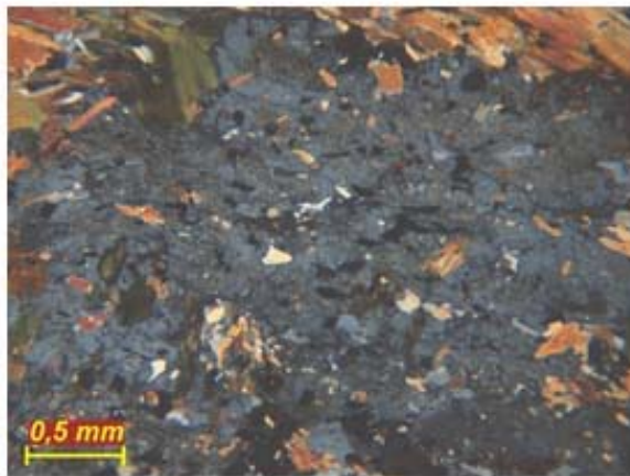
Figura 29. Vista de un poiquiloblasto de plagioclasa (posible oligoclasa) sericitizada, propia de una textura poiquiloblástica, de rápido crecimiento durante el metamorfismo. En el interior del cristal, se presentan inclusiones de muscovita, biotita, opacos de limonita y otras impurezas minerales. Aumento: 4X. Fotomicrografías: Superior: NP. Inferior: NC.
