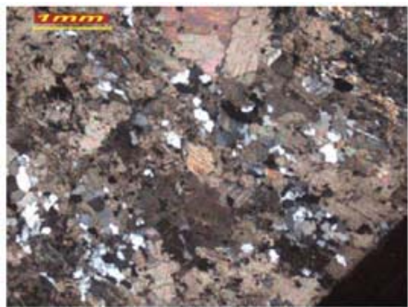
Figura 2. Se observa otra zona del mármol cuarzoso, con una mayor alineación de cristales de cuarzo, evidencia de una foliación incipiente. En la imagen superior, se observa el maclado en diagonal de algunos cristales de calcita, y trazas de mineral opaco de limonita. Aumento: 2,5X. Imagen superior: NP. Imagen inferior: NC.
