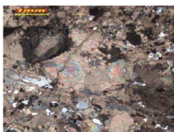
Figura 3. En la fotomicrografía superior se aprecia la calcita algo fracturada, y la presencia de limonita en esas zonas de fractura y sutura. En la imagen inferior, se observa un intercrecimiento entre cuarzo y calcita, y una alineación pobre de cuarzo. También, se observa la presencia de cristales de calcita con cierta alteración a limonita. Aumento: 2,5X. Vista superior: NP. Vista inferior: NC.
