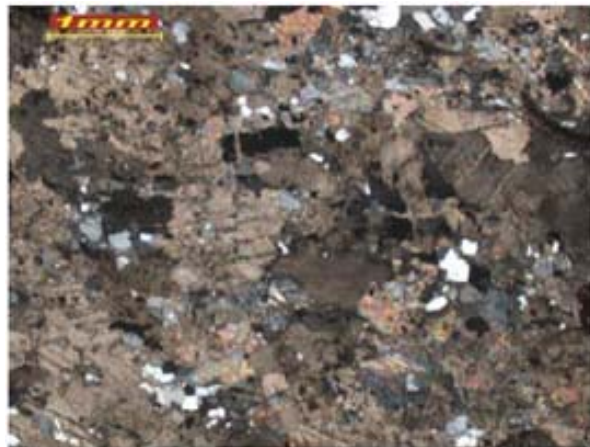
Figura 1. Fotomicrografía del mármol cuarzoso, en donde se aprecian cristales de calcita con macla polisintética, y algunos trenes de cuarzo con una leve orientación. Aumento: 2,5X. Imagen superior: Nicols paralelos (NP). Imagen inferior: Nicols cruzados (NC).
