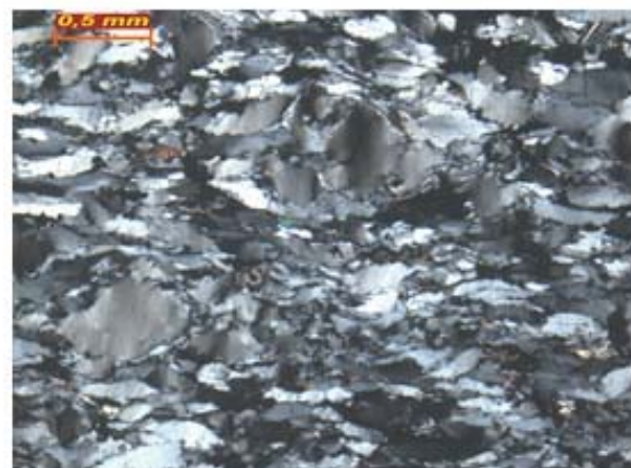
Figura 14. Se aprecia una vista general de la cuarzita esquistosa, en donde se observa el empaquetamiento y sutura de los trenes de cuarzo alineados, que obedece a una foliación fuerte, definida por niveles de muscovita,
