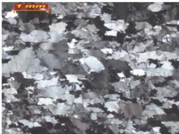
Figura 17. Vista general de la cuarcita con esquistosidad incipiente. Se observan granos de cuarzo de tamaños variable, suturados entre sí y alineados medianamente en sentido horizontal en la microfotografía, obedeciendo a una foliación incipiente, producto de un metamorfismo de bajo grado. Aumento: 2,5X. Fotomicrografías: Superior: NP. Inferior: NC.
