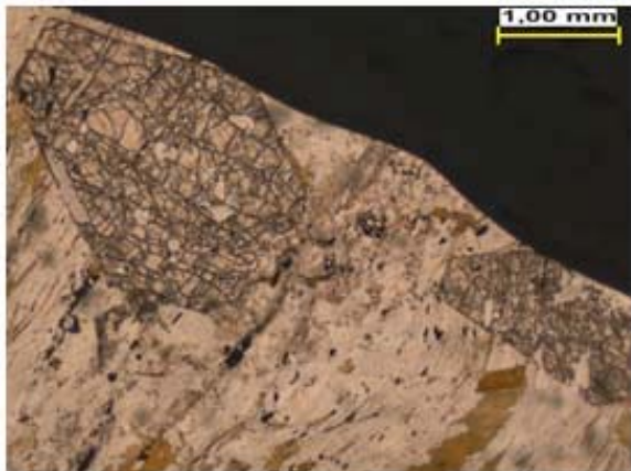
Figura 22. Se ve en el centro de la imagen un cristal de porfidoblasto de estaurolita, en el cual se aprecia un maclado de penetración, con orientaciones perpendiculares similar a una T. En nicoles paralelos, este cristal presenta cierto pleocroísmo marronusco, con alto relieve, color de interferencia gris del primer orden, y presencia de fracturas. En su interior, se presentan inclusiones de granates pequeños. En la parte inferior, se observan bandas lepidoblásticas de mica muscovita y biotita. En la parte superior, se aprecia a la izquierda un cristal de plagioclasa poiquiloblástica, y a la derecha restos de un cristal de granate y otros fragmentos de estaurolita. Aumento: 2,5X. Fotomicrografías: Inferior derecha (página anterior): NP. Superior izquierda: NC.
