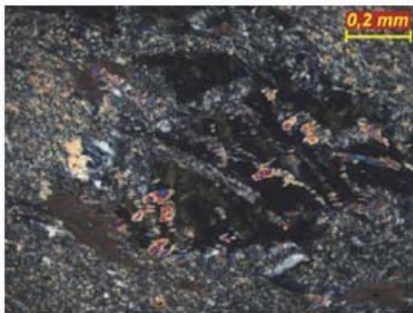
Figura 9. Vista central de un cristal de clorita con textura reliquia óptica a subóptica, donde se observa un intercrecimiento de oicocristales de plagioclasa cálcica (posible oligoclasa) epidotizada. También, se aprecian dentro del cristal de pseudomorfo cloritizado fragmentos residuales sin alterar de clinopiroxeno (augita). La imagen corresponde a un ejemplo de la zona de metadiabasa presente en la muestra. Aumento: 10X. Fotomicrografías: Superior: NP. Inferior: NC.
