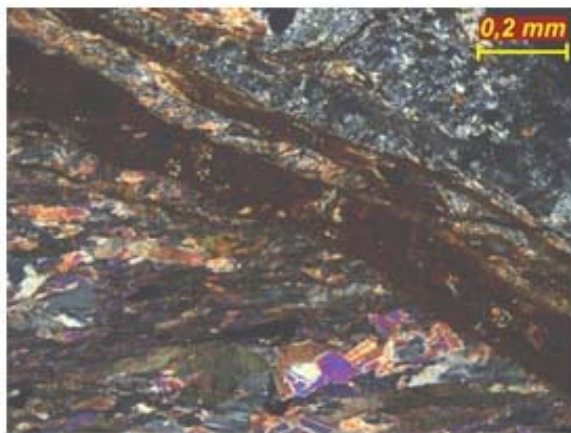
Figura 31. Vista adicional de la vetilla hidrotermal postmetamórfica, en donde se aprecia a nivel inferior, cristales de clorita a ambos lados externos de la veta. También, se observa clorita embebida en el interior de la vetilla. Debajo de la veta hay trazas de rutilo y titanita, y su alteración a leucoxeno. En la parte superior de la vetilla se presenta epidoto, clorita y cuarzo. En la zona inferior de la sección fina se presenta cuarzo, muscovita y biotita. Aumento: 4X. Fotomicrografías: Superior: NP. Inferior: NC.
