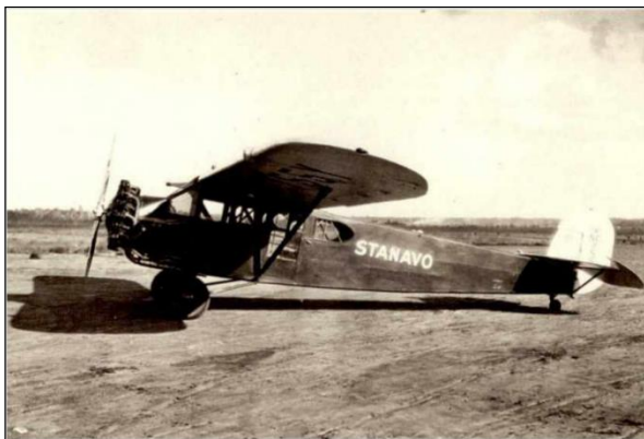
Figura 15. Avión Fairchild F-71, el cual estaba dotado con cámara de fotografía aérea. Con este avión se levantaron mapas del Delta del Orinoco y gran parte del oriente del país. Tomado de Lagoven (1985).
