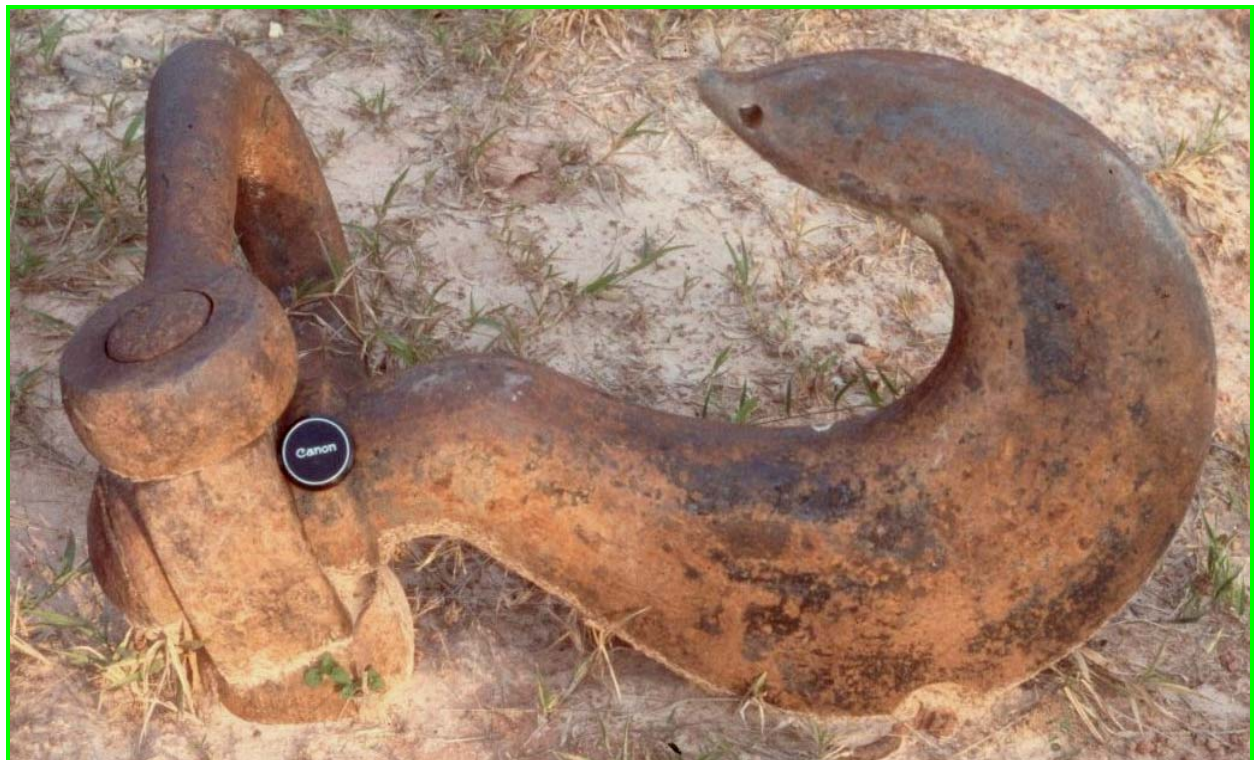
Gancho maestro de la cabria de perforación
