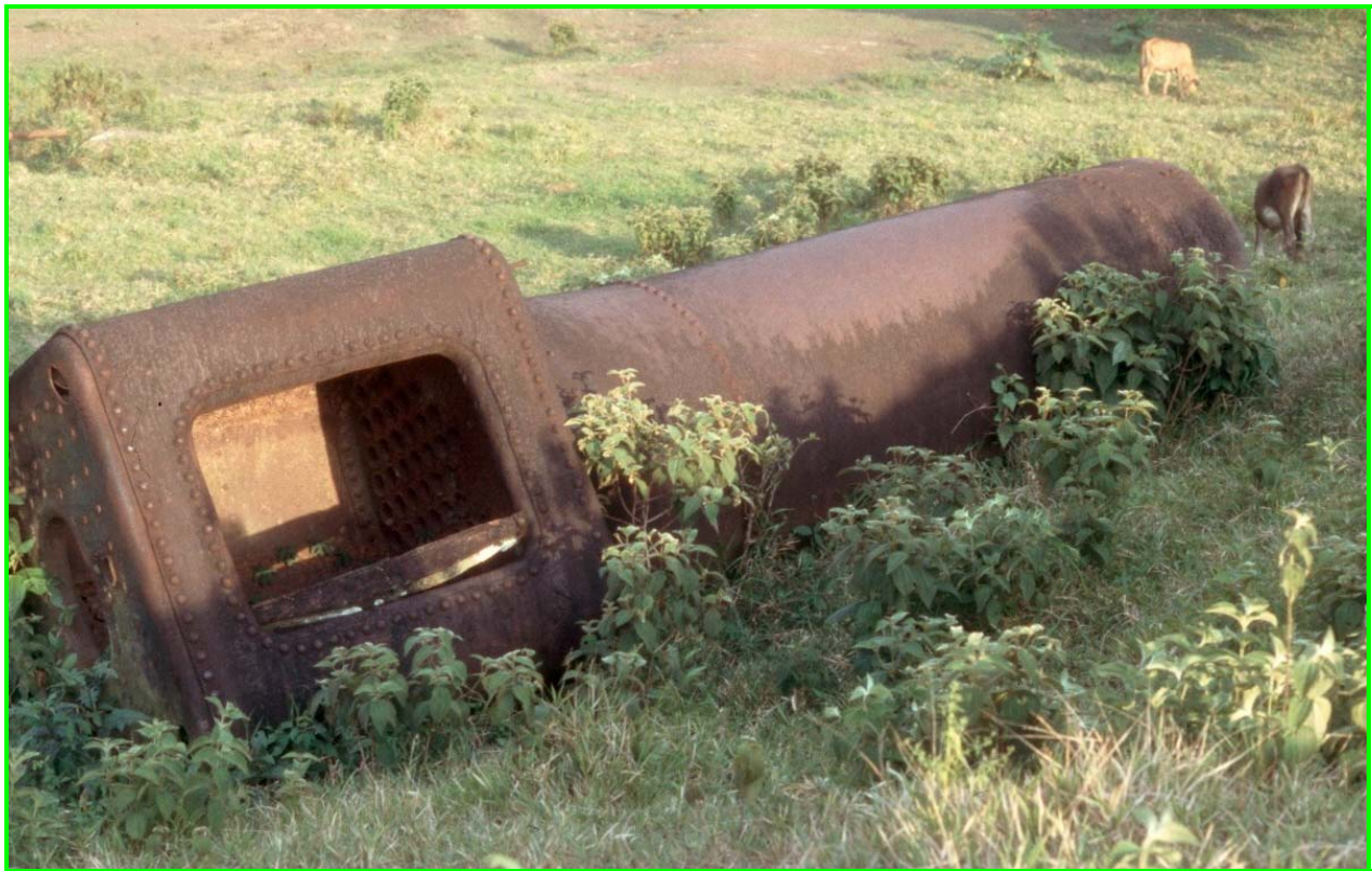
Probablemente corresponda a una caldera de vapor del motor necesario para realizar la perforación.
