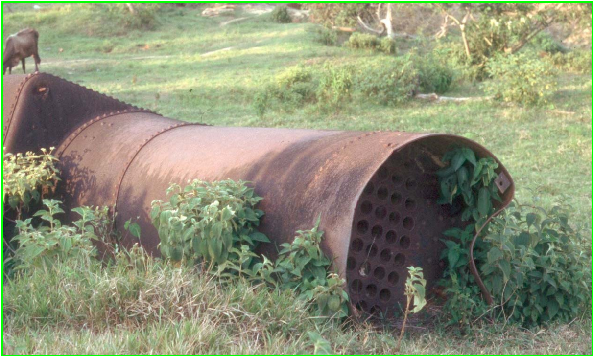
Probablemente corresponda a una caldera de vapor del motor necesario para realizar la perforación.
