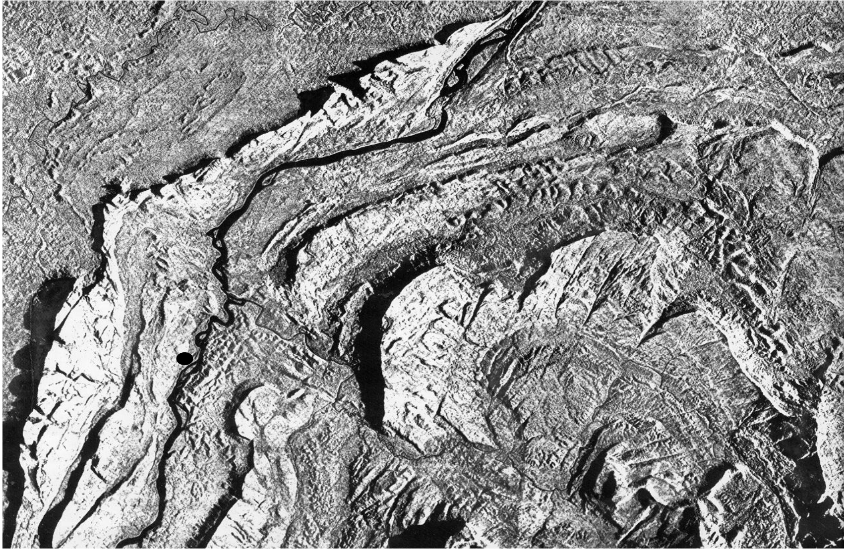
Figura Nro 42 HOJA DE RADAR NB20-6 (ESCALA 1:250000 ) MOSTRANDO CIZALLA N20-25E SALTO AURAIMA RIO PARAGUA, MINA MANAIMA CON MINERALIZACION AURIFERA EPITERMAL HOSPEDADA EN ARENISCAS ORTO-CUARCITICAS DEL GRUPO RORAIMA
