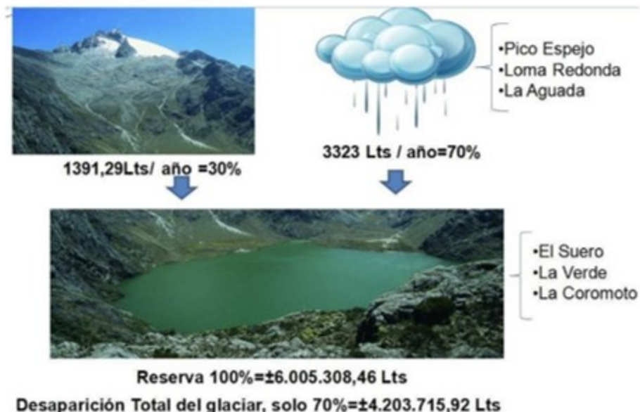
Figura 11. Balance sobre la reserva en los Humedales Alto Andinos de la cuenca La Mucuy- La Coromoto y la p6rdida total del glaciar.
