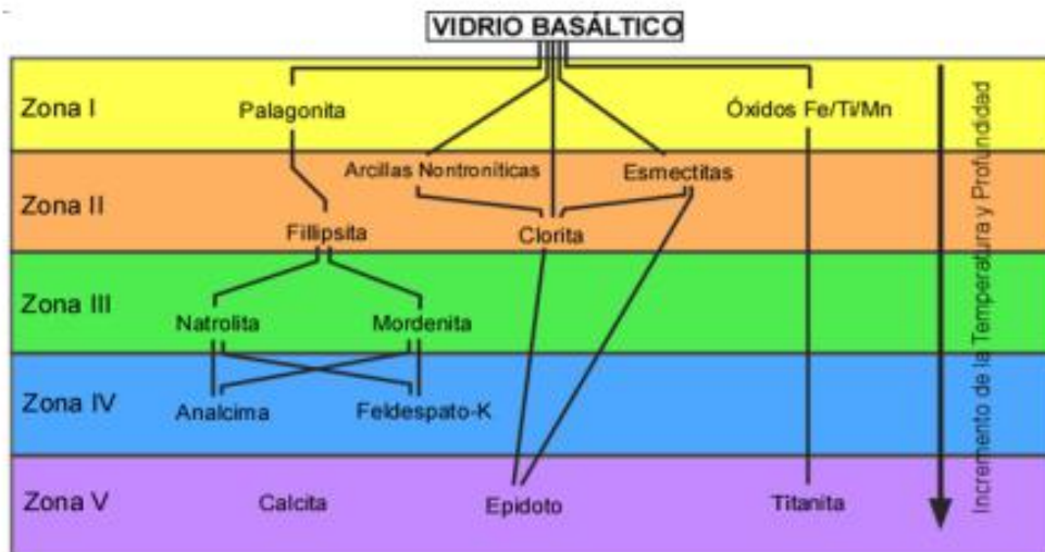
Figura 37. Diagrama de flujo mostrando el desarrollo de conjuntos minerales durante la diagénesis del vidrio basáltico. La secuencia de la parte izquierda va desde palagonita a zeolitas sódicas y a calcita, y puede observarse en los fragmentos vítreos y en la matriz vítreas de las lavas de las hialoclastitas. La secuencia de la parte central, desde esmectitas (saponita) a clorita, pudiera aplicarse a la alteración de los fenocristales máficos en la lava basáltica y los fragmentos lávicos en la hialoclastita. La Zona V que genera titanita no se observa en el TOC-1S, quedando reducida esta secuencia a la Zona I, con algunos bordes oxidados de los fragmentos de vidrio y lavas. Modificado de GIFKINS (2001).
