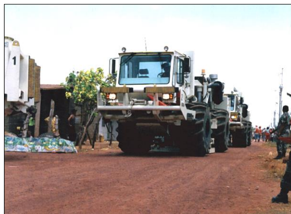
Figura 9. Adquisición sísmica 3D Campo La Concepción (1999-2000). La fotografía muestra el paso de un camión vibroseis por el poblado de La Concepción. Por encontrarse el yacimiento en el subsuelo justo debajo del poblado en el área Concepción Norte, la imagen de la sísmica 3D resultó de inferior calidad a niveles del Eoceno. Esta situación no solo influyó en la interpretación, sino que vino acompañada de los reclamos vecinales por puestos de trabajo e indemnizaciones por ruido, contaminación, afectación al ganado y deterioro de las viviendas (Fuente: Pecom 2002).
