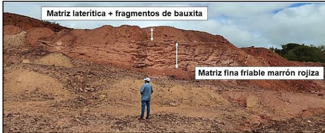
Figura 3 – Descripción concisa de la zona basal remanente en el cerro Mesa de La Carata, donde se observan claramente, la zona superior laterítica y la inferior, predominantemente arcillosa. Fuente: cortesía de CVG (2023).
