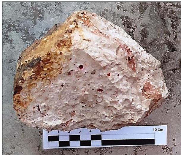
Figura 4 – Muestras de mano del duricrust de bauxita del cerro El Chorro con costra ferruginosa (izq.) y abundantes pisolitas equigranulares, de color blanco, con diámetro entre 0,5-0,6 mm, con contenido análogos de bohemita y gibsita. Fuente: colección de minerales del autor.
