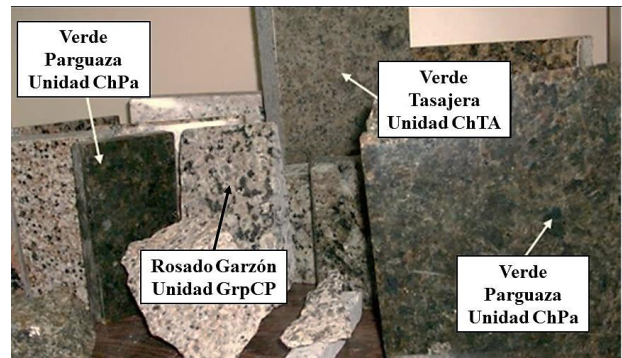
Figura 6. Muestras pulidas donde se observan dos tonos de color verde (ChPa y ChTA), que se identificaron como charnockitas fayalíticas (bauchita) y uno del tono rosado (GrpCP), identificado como sienogranito, que muestran los patrones y diversas texturas de las rocas ornamentales de la zona del Bajo Parguaza, así como el atractivo, belleza y calidad que atraen a los inversionistas y clientes.
