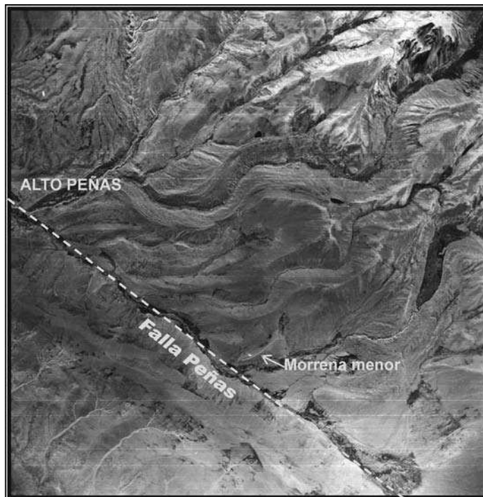
FIG. 5.2.3.2. Fotografía aérea mostrando la traza rectilínea de la Falla Alto Peñas. Escala: 1:100.000.
