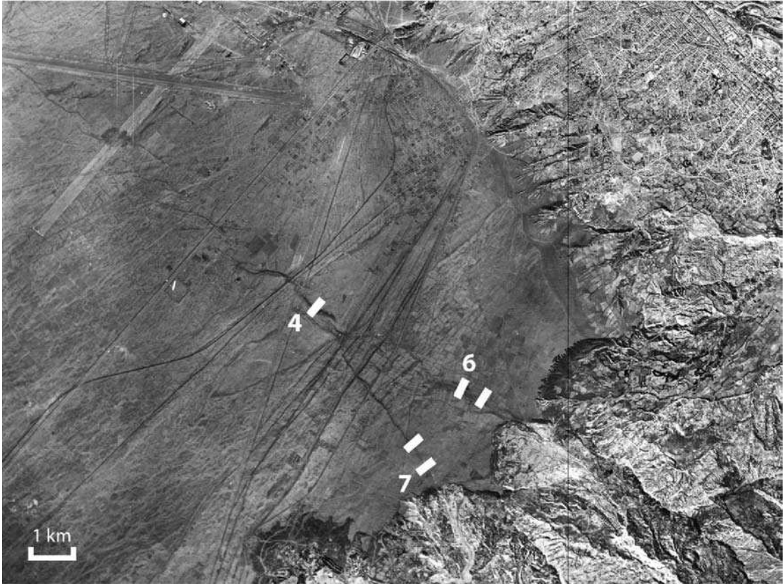
FIG. 5.2.2.2. Fotografía aérea del año 1955 donde se aprecia los escarpes del sistema de fallas El Alto. Las líneas blancas indican secciones medidas detalladamente con GPS diferencial; los números hacen referencia a figuras siguientes.
