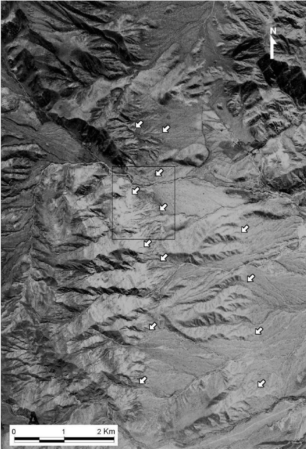
FIG. 5.1.4.2. Fotografía aérea del sector central del sistema de fallas. Se indican, de izquierda a derecha, las fallas frontal, Río Blanco y El Salto. El recuadro corresponde al sector del frente montañoso que se observa en la Figura 5.1.4.3.
