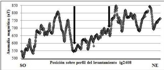
Figura 7. Perfil magnético SO-NE, grupo 1, se destacan con flechas negras posición de fallas Figure 7. Group 1 SW-NE magnetic profile (black arrows show fault location)
