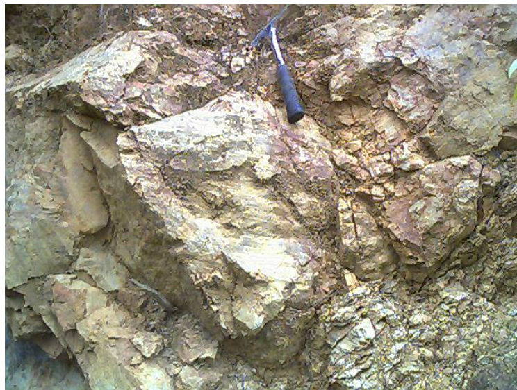
Figura 7.2.32. Planos estriados de la estación 36. Rumbo de la foto: N-S.
