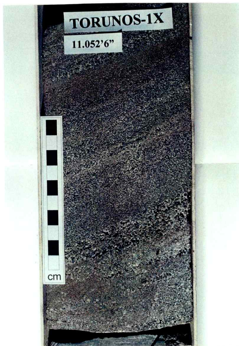
Fig. 3. Arenisca con estratificación cruzada festoneada impregnada de hidrocarburos (Arena P, Fm. Escandalosa).
