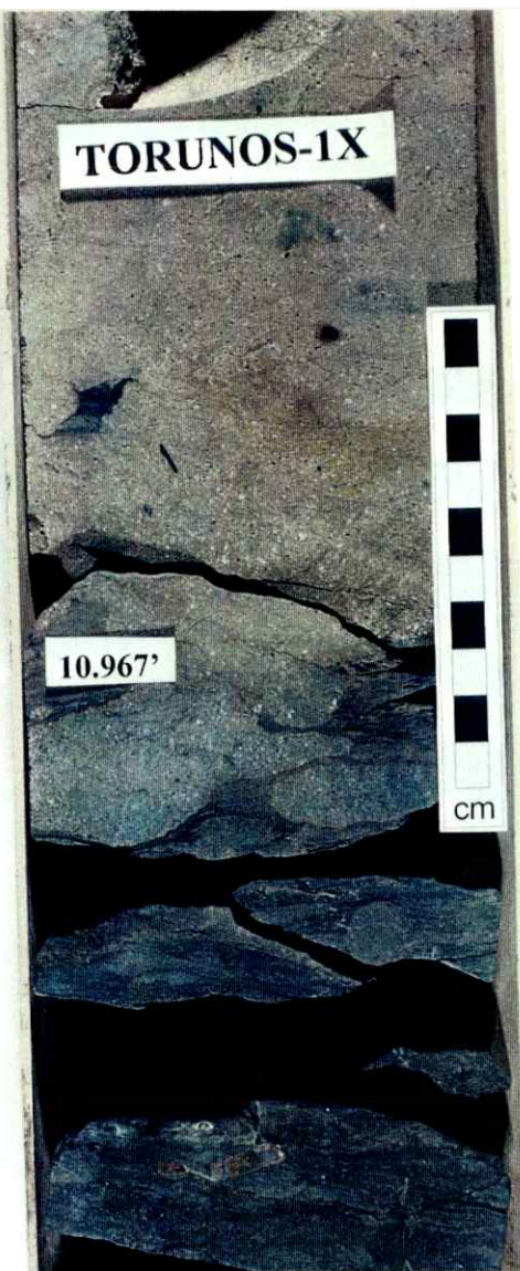
Fig. 7. Contacto erosivo y bioturbado con trazas de Thalassinoides entre la arena P (base) y caliza O (tope).
