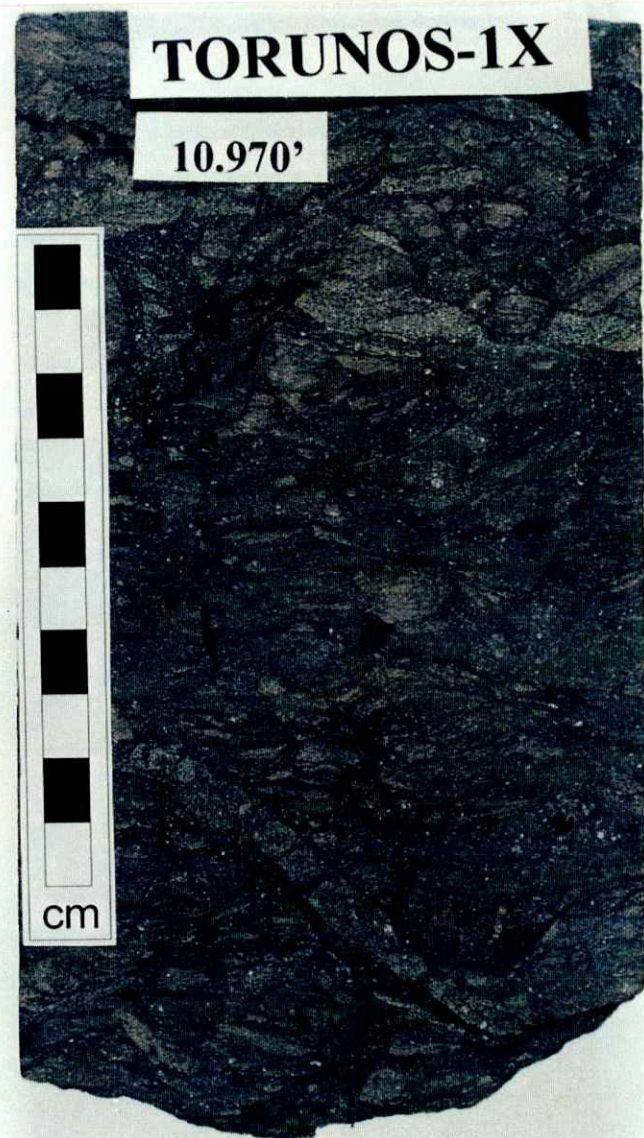
Fig. 5. Limolitas altamente bioturbadas con trazas de Tiechichnus . (Arena P, Fm. Escandalosa).
