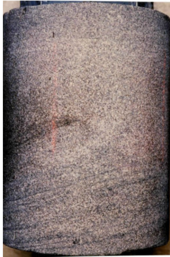
Figura 5. Núcleo 10-12-57-19W5 (Formación Bluesky, Alberta, Canadá). Profundidad: 2664 metros. Sutil contacto irregular entre una arenisca con estratificación cruzada muy difusa (mitad inferior) y una arenisca similar, pero totalmente bioturbada por meiofauna y sin estructuras visibles (mitad superior). Diámetro del núcleo: 4 pulgadas. Fuente: [12]
