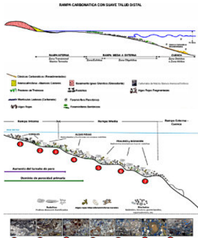
Figura 2. Modelo sedimentológico: carbonatos del área de Perla (arriba). Tomado de Pinto et al., (2014). Esquema deposicional de la distribución de las facies sedimentarias establecidas del pozo Perla en una rampa carbonática (abajo). Tomado de Palacios (2013).
