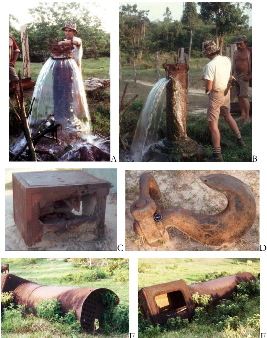
**Figura 4.32.** Fundo Milamores, sitio del antiguo Campamento 2 del pozo PERITO-1. **A y B:** Dr. Daniel Loureiro junto a los restos del pozo PERITO-1, ahora un pozo artesiano donde brota agua a 48°C. **C:** Caja fuerte. **D:** Gancho de la cumbre de la torre de perforación. **E y F:** Restos de una caldera a vapor.
