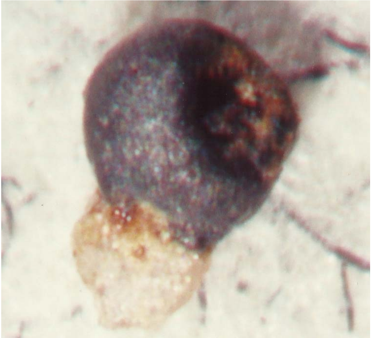
Microesfera metálica algo oxidada adherida a una partícula silicatada. Ancho 1 mm.
