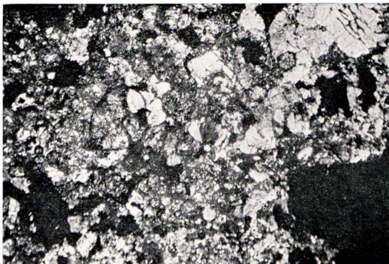
FIGURA 3: Fotomicrografía de una sección fina del meteorito bajo luz polarizada. (200 X).
