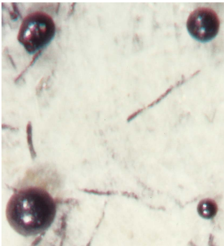
Cuatro microesferas metálicas (fracción magnética). Ancho 1 mm.
